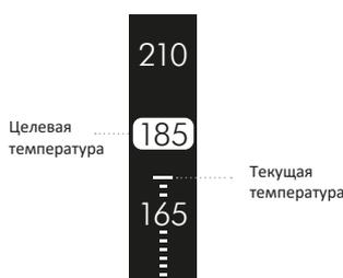
На экране с температурой имеется шкала до 210 с выделенной целевой температурой и текущей температурой, отображаемой на шкале.
