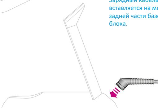
Зарядный кабель вставляется на место в задней части базового блока.
